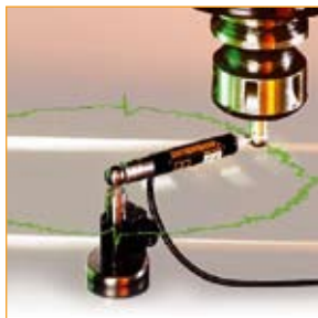
Systém QC10 ballbar – rychlé testování přesnosti obráběcího stroje
