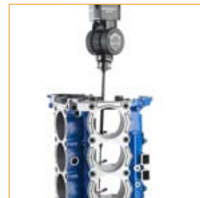
REVO™ – snímací systém se skenovací servohlavicí
