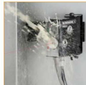
TRS2 – systém k detekci poškození nástrojů
