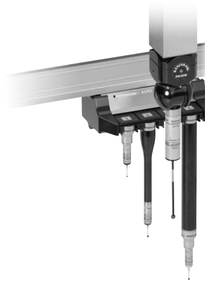
MRS Befestigungssystem mit einem ACR3 Tasterwechselsystem
