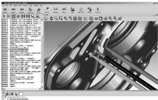
Kollisionserkennung – Simulation des Messablaufs mit Erkennung und Behebung von Kollisionen
