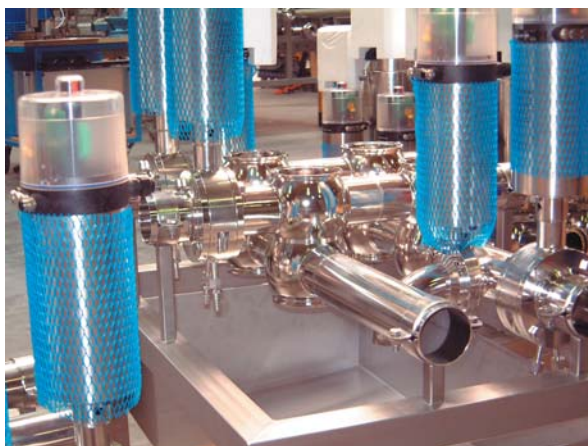
Bild 1: Dicht halten: Nur genaues Fertigen gewährleistet die sichere Funktion von Leakagegehäusen
