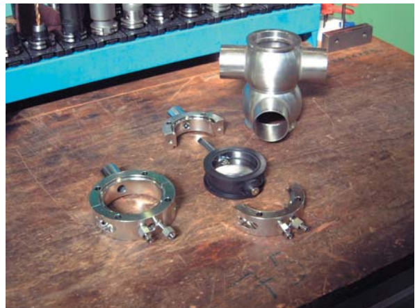
Bild 2: Vom Teil zum Ganzen: An den zweiteiligen Leakagegehäuse sind auf Bearbeitungszentren genau fluchtende Bohrungen einzubringen
