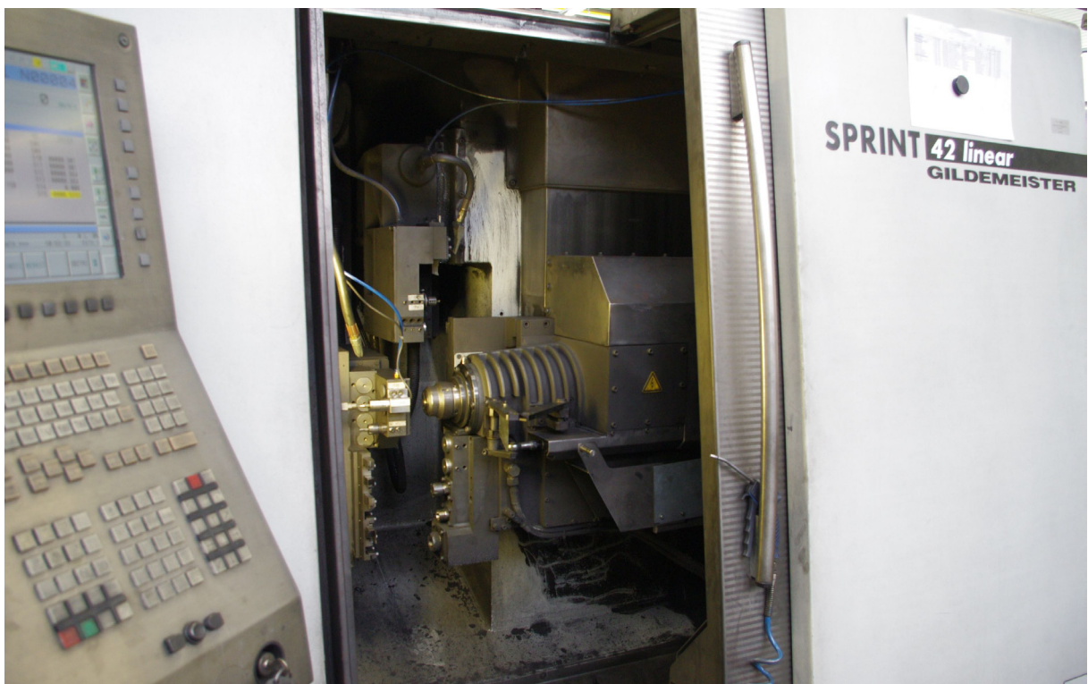
Lagerbuchsen aus Graphit für den Fahrzeugbau sind in großen Serien bei gleichbleibend hoher Qualität zu fertigen.
