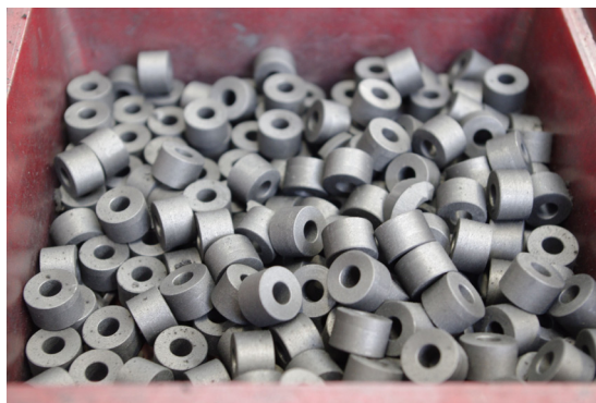
Wegen seiner spezifischen Vorteile hat sich Graphit als Werkstoff für Erodier Elektroden und Maschinenelemente in zahlreichen Anwendungen bewährt.
