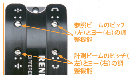
RLD10 ディファレンシャル干渉計ディテクターヘッドのビームステアリング機能
