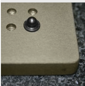
用于在比对仪上重新定位底板的定位球
