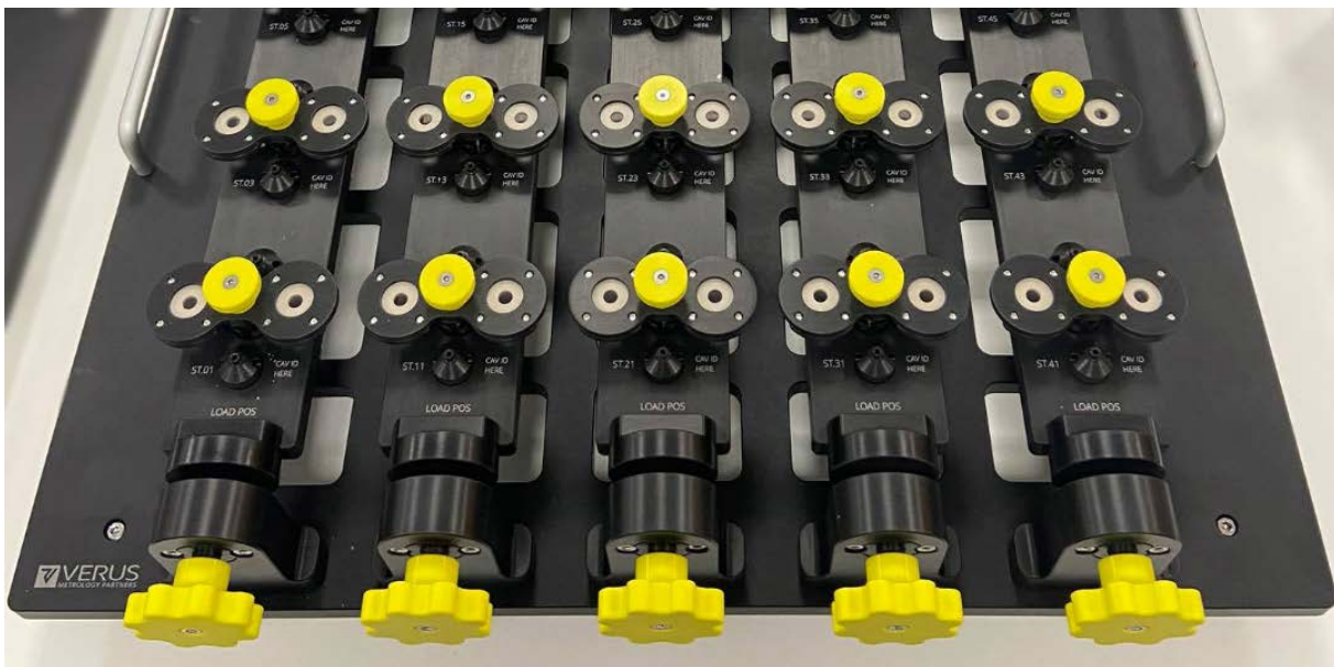
Estación de fijación a medida Verus para medir 48 componentes de goma blanda
