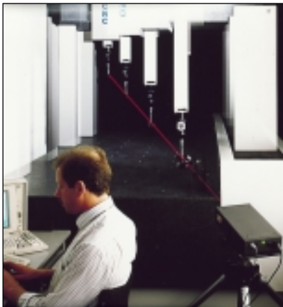
Calibración espacial-diagonal de una MMC usando el sistema de medición por láser.
