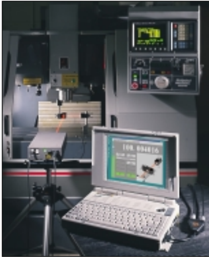
Calibración del eje lineal de una máquina-herramienta usando el sistema de medición por láser
