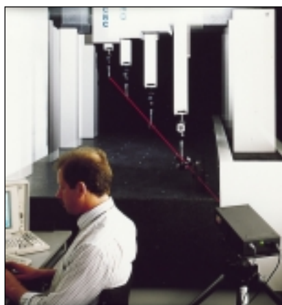
Calibration d'une diagonale d'une MMT avec un système de mesure à laser.
