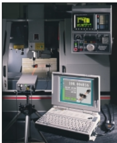
Calibration d'un axe linéaire d'une machine-outil en utilisant un système de mesure à laser.
