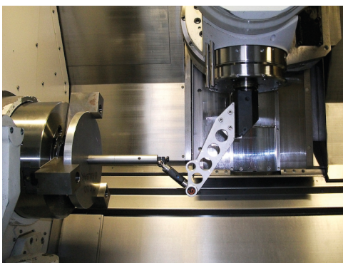
CNC 旋盤のテストを実施する QC20-W ボールバー
