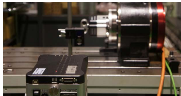
レニショー製 XL-80 レーザー測定システム (手前) と XR20-W 回転軸割出し角度測定装置 (上の写真と同じ)
