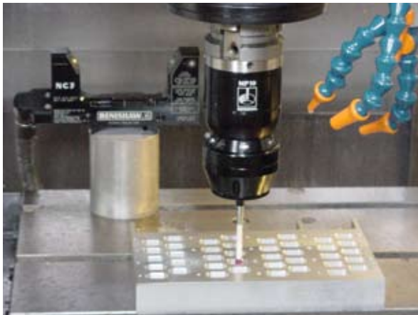
De MP10 spindeltaster stelt een farmaceutisch onderdeel in. Op de achtergrond een NC3 contactloos gereedschapinstelsysteem.
