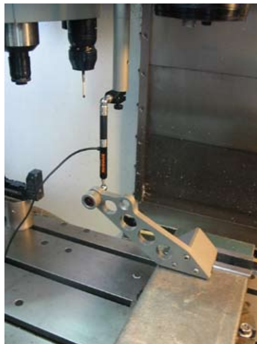
Een QC10 ballbar die de XZ-positioneringsnauwkeurigheid controleert van een HAAS machine bij TJW. Spindel-tasters en contactloze systemen voor gereedschapinstelling transformeren de insteltijden en consistentie.
