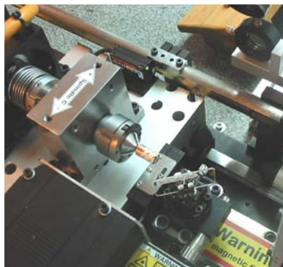
En Citam-maskin som använder Renishaw mätskala monterad på en Invar-stav för noggrann positionering
