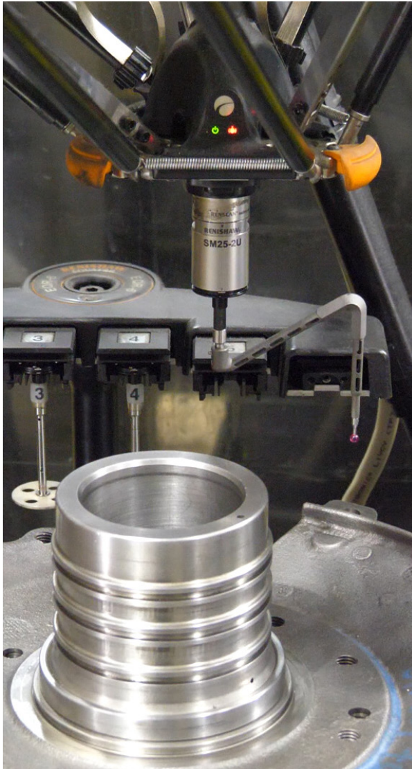
在 Equator 300 檢具系統上使用積層製造測針檢測汽車零組件
