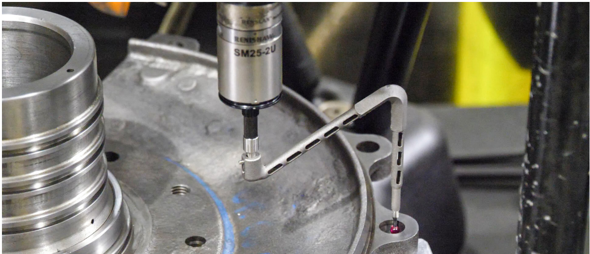
在 RenAM 500Q 系統上藉由金屬 3D 列印技術打造的客製化測針
