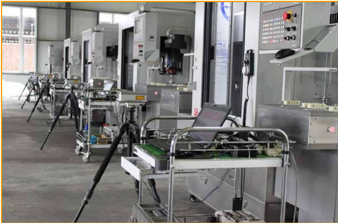
精雕公司在装配车间批量使用激光干涉仪
