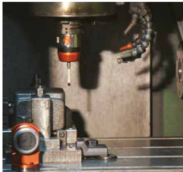
使用Primo系统测量泵体铸件的壁厚偏差
