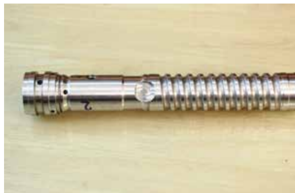
Primo系统帮助在立式加工中心上精确定位转向蜗杆轴，以执行铣槽加工
