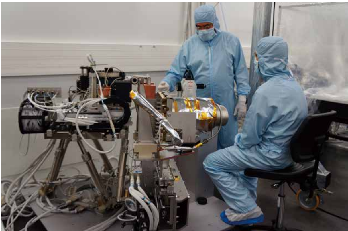
IA DEA (图中右侧部分，带有金/银镀层) 测试设置。SYMÉTRIE六轴机器人在图中左侧。 图片来源: BERTIN Technologies / SYMÉTRIE。
