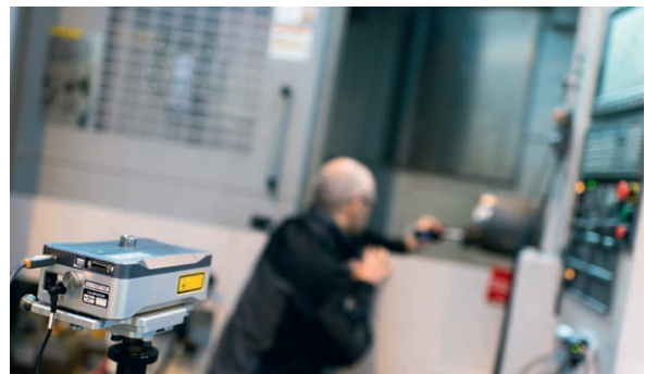
FMC Technologies公司维护技师Craig Simpson使用XL-80激光校准系统检查机床精度
