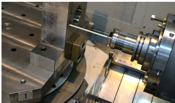
FMC Technologies公司的一台机床正在使用RMP60触发式测头
