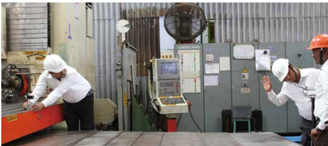
Godrej技术人员正在使用XL-80激光干涉仪对数控机床进行校准
