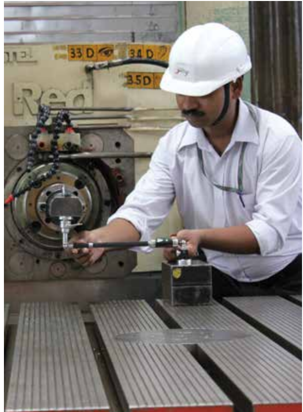
Godrej制造工厂的工作人员正在准备进行QC20-W球杆仪测试
