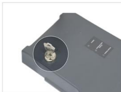
MCU W-2锁定位置“关闭”，操纵杆已禁用
