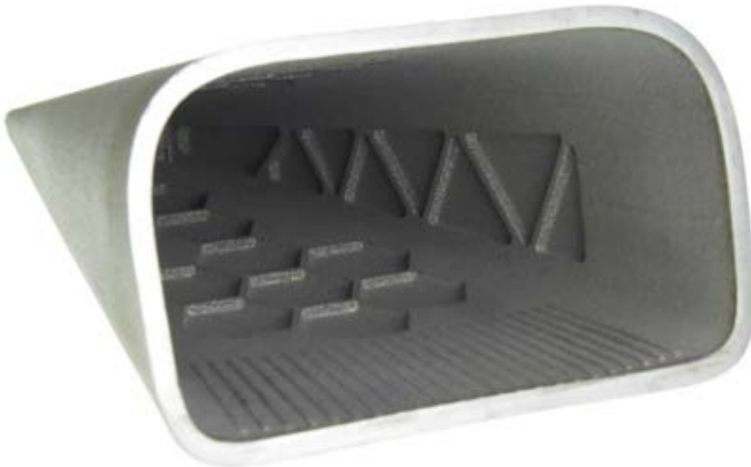
Dutá špička z titanové slitiny (Ti-6Al-4V) s viditelnou vnitřní strukturou
