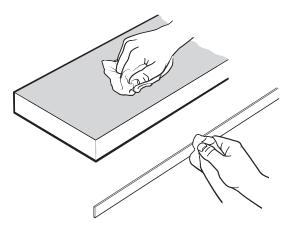
Die Fläche für den Epoxidkleber auf dem Klebeband markieren und es entsprechend abschneiden. Die Referenzklemme fixiert die Maßverkörperung an der gewünschten Stelle fest auf dem Untergrund.
