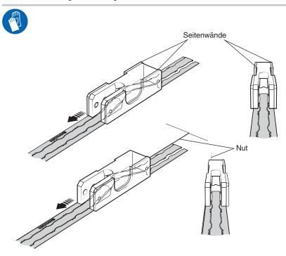
6. Führen Sie das RTLA30 Maßband in das FASTRACK ein. Vergewissern Sie sich, dass das Maßband wie unten dargestellt unter den Auskragungen verlegt wird.
