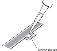
Stellen Sie sicher, dass der Kleber über die gesamte Länge der Öffnung verteilt ist.
