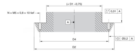
Die Abmessungen D1, D2, D3, D4 und die Anzahl der Bohrungen N finden Sie im Abschnitt "Abmessungen REXA30 Ring" auf Seite 39.
