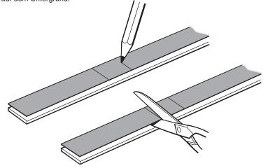
Die Schutzfolie des doppelseitigen Klebebands auf einer Seite entfernen und auf die Unterseite des Maßstabs kleben.
