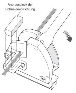
Halten Sie den Block fest in seiner Position und ziehen Sie gleichzeitig den Hebel zum Schneiden des Maßbands in einer fließenden Bewegung nach unten.
