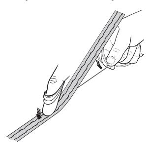
Drücken Sie das FASTRACK an, indem Sie mit dem Finger fest von der Mitte in beide Richtungen streichen. Verwenden Sie hierbei gegebenenfalls ein faserfreies Tuch.
