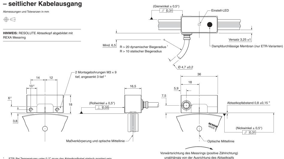
ETR: Bei Temperaturen unter 0 °C muss das Abtastkopfkabel statisch montiert sein.
