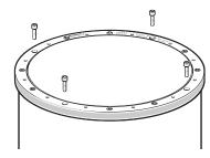
Schrauben in die verbleibenden Montagebohrungen einsetzen.
