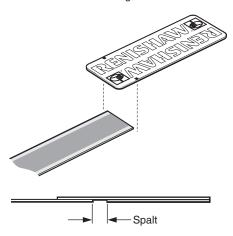
**HINWEIS:** Zwischen dem Maßbandende und dem Klebeband an der Endabdeckung entsteht ein Spalt.
