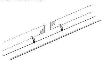
4. Den Epoxidkleber gründlich mischen und auftragen. Dann die restliche Schutzfolie entfernen.
