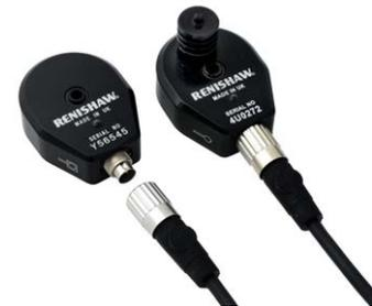
Die abgebildeten Sensoren für Lufttemperatur und Materialtemperatur sind zwei unterschiedliche Messvorrichtungen und werden komplett mit Kommunikationskabeln geliefert. Jedes Kabel besitzt eine Gewindebuchse zum Anschluss an den Sensor sowie einen Gewindestecker zum Anschluss an die entsprechende Buchse an der Seite der XC Kompensationseinheit.
