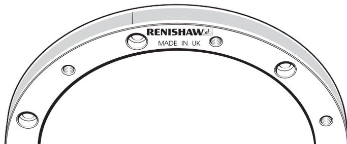
Die *IN-TRAC*™ Referenzmarke ist in der Inkrementinformation integriert und radial ausgerichtet. Die Position der Referenzmarke ist immer über der Befestigungsbohrung links vom Renishaw Logo innerhalb  $\pm 0,5$  mm. Externe Geber bzw. eine Justage sind nicht erforderlich.
