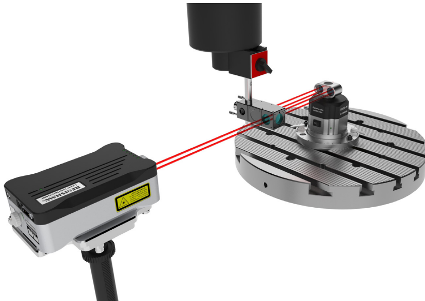
Abbildung 1 Typische Konfiguration für die Drehwinkelmessung unter Verwendung eines XL-80 als Referenzlaser
