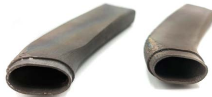
Componente de titanio del basculante impreso en 3D en el sistema RenAM 500S
