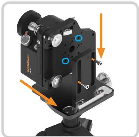
Sujete la unidad emisora en la base, en el soporte de 90 grados con los tornillos.
