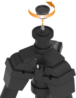
Retire el adaptador de la plataforma del trípode de la parte superior.
