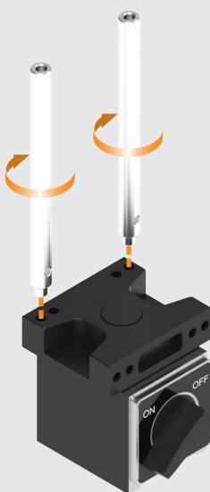
Atornille los pilares en la base rotatoria.
