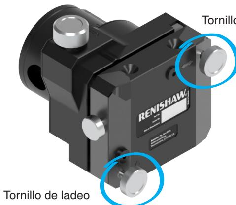
Los tornillos de cabeceo y ladeo se utilizan para ajustar la óptica del pentaprism de forma que esté paralela a la unidad emisora y al raíl de medición.
