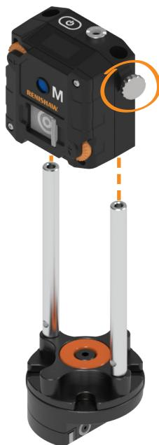
Atornille los pilares en la base rotatoria.
