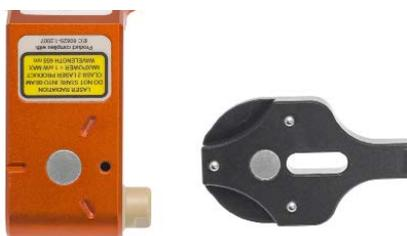
3. El marco de fiducial del *neurolocate* se fija cinemáticamente al soporte del puntero láser en el brazo del *neuromate*, para garantizar un posicionado preciso.
