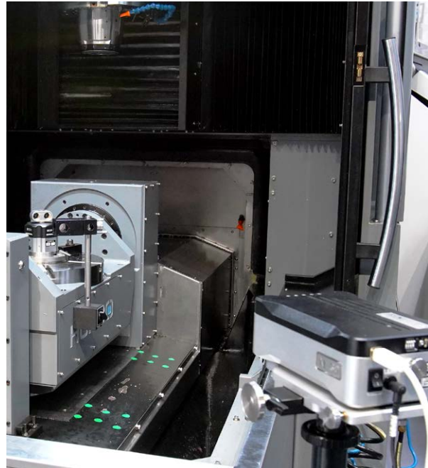
Hurco utilise également le système d'interféromètre laser XL-80 de Renishaw et le calibre d'axe rotatif XR20-W
