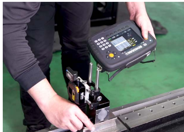
Unité d'affichage XK10 permettant de collecter, d'analyser et d'enregistrer les données de mesure
