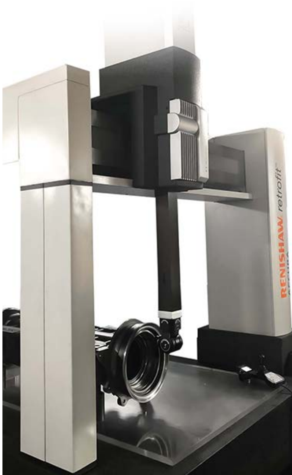
A REVO egy mozdony üreges tengelyének mérése közben
