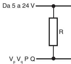
**NOTA:** selezionare il resistore R in modo che la corrente massima non superi i 20 mA. In alternativa, usare un relè o un optoisolatore adeguato.
