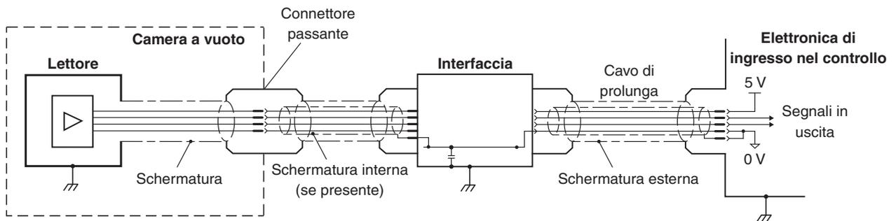
**IMPORTANTE:** la schermatura esterna va collegata alla terra della macchina. La schermatura interna va collegata a 0 V solo nell'elettronica d'ingresso del controllo. Assicurarsi che le due schermature (interna ed esterna) NON siano in contatto tra loro. Un eventuale contatto provocherebbe un corto circuito fra 0 V e la terra e potrebbe introdurre disturbi nel sistema.
