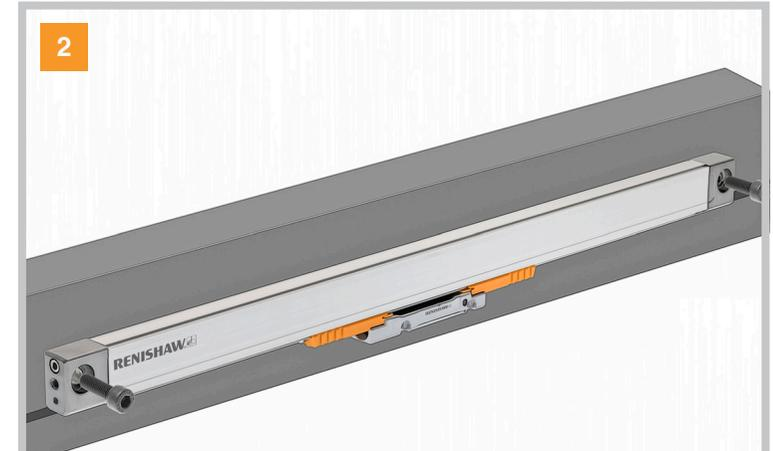
Fissare (senza serrare eccessivamente) l'estruso alla superficie di montaggio, posizionando le due rondelle dentellate e le viti M8 nei fori di montaggio del cappuccio.
