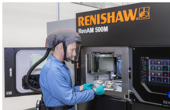
Rimozione dei pezzi dimostrativi per Land Rover BAR dalla Renishaw RenAM 500M
