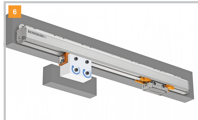
6 Allineare la guida di scorrimento dell'asse con la staffa del lettore e fissarlo con viti M6.
