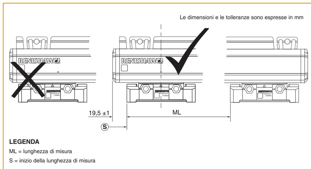
**AVVISO:** se il lettore non dovesse trovarsi all'interno della lunghezza di misura dell'encoder, potrebbero verificarsi collisioni con conseguenti danni al sistema.
