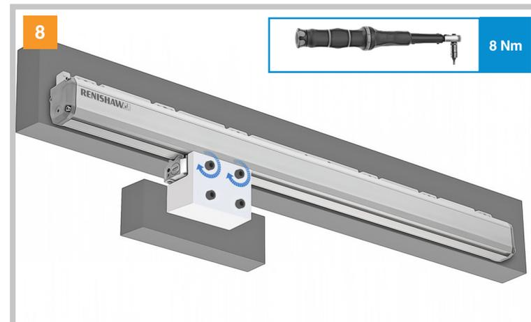
8 Allineare il lettore alla staffa di montaggio e fissarlo con viti e bulloni M6. Usare un utensile adeguato per serrare le viti con una coppia di 8 Nm.
