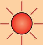
ROSSO<br>LAMPEGGIANTE | Impossibile determinare la posizione | <b>NOTA:</b> il lampeggio del LED indica un errore di lettura. Per alcune interfacce seriali lo stato di lampeggiamento è bloccato.<br>Disconnettere l'alimentazione per resettare.                                                                               |
