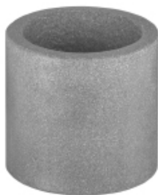
図 1 表面仕上げ 16Ra の炭化ケイ素製テストパーツ
