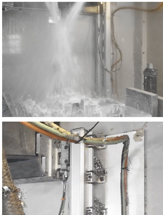
図 3.エンコーダでエアブローを使用することで、極端な条件下でもエンコーダ内への異物の侵入を防ぐ。
