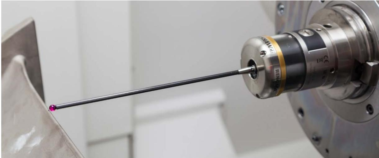
エアフォイルの位置を計測する RMP600 工作機械用プローブ
