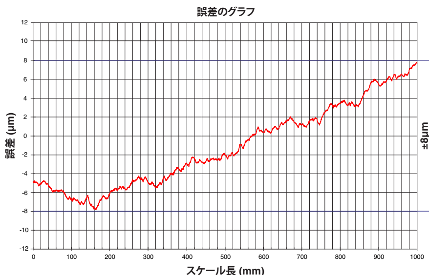
長さ 1000mm の RTLA50 スケールの精度テストの例
