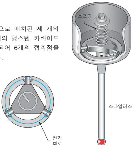
스프링 하중을 받는 상태에서, 전류가 흐르는 로드와 볼 사이에 접촉식 패치가 만들어집니다. (접촉하는) 공작물과 접촉하는 동안 스타일러스를 통과하면서 바뀌는 힘이 볼과 로드를 이동시켜 분리시키는데, 이때 접촉 패치 크기가 줄어들고 전기 저항이 커집니다.
