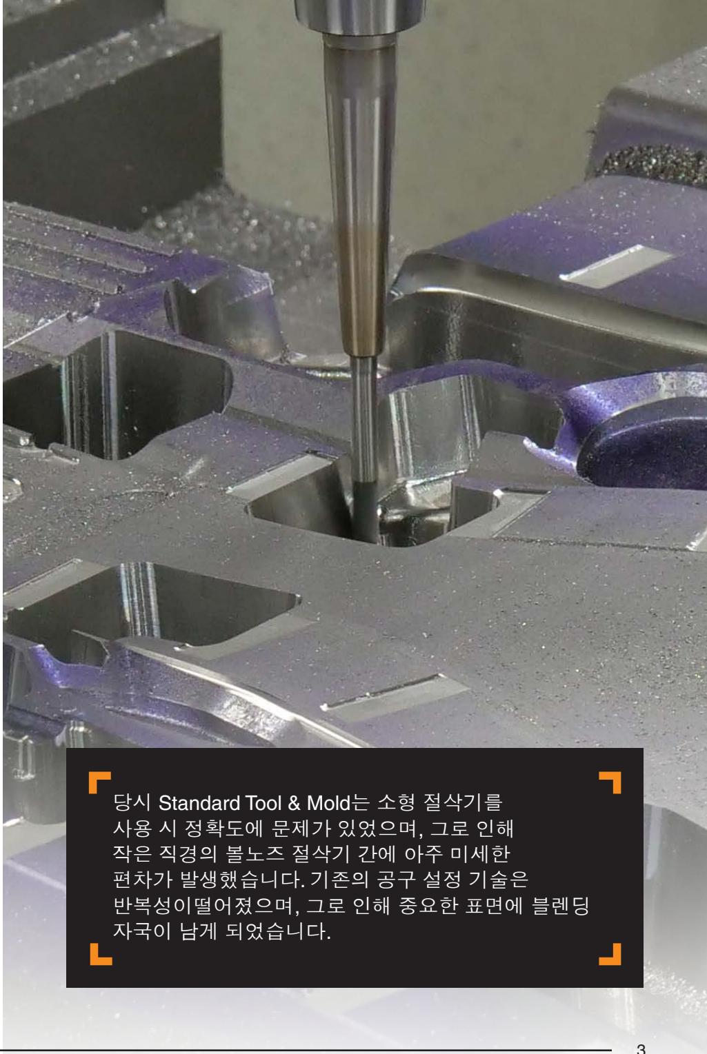
당시 Standard Tool & Mold는 소형 절삭기를 사용 시 정확도에 문제가 있었으며, 그로 인해 작은 직경의 볼노즈 절삭기 간에 아주 미세한 편차가 발생했습니다. 기존의 공구 설정 기술은 반복성이 떨어졌으며, 그로 인해 중요한 표면에 블렌딩 자국이 남게 되었습니다.
