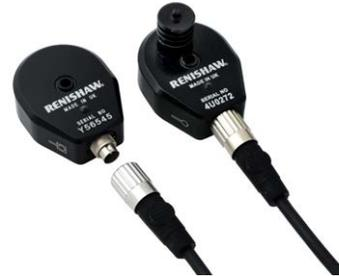
표시된 공기 온도 센서와 물질 온도 센서는 별도 품목이며, 각각의 통신 케이블과 함께 제공됩니다. 각 케이블에는 센서에 체결되는 너트형 커넥터와 XC 보정 시스템 측면의 대응 소켓에 체결되는 볼트형 커넥터가 있습니다.
