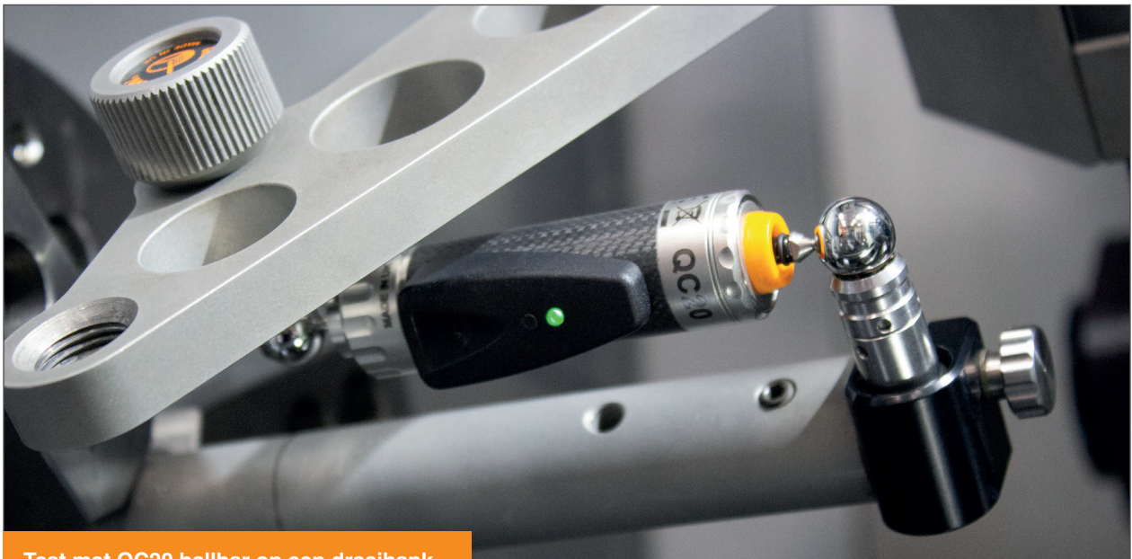
Test met QC20 ballbar op een draaibank
