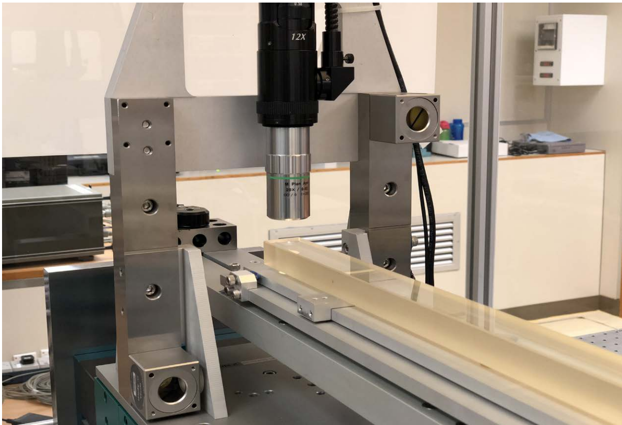
Kalibratie van een glazen meetschaal van 500 mm
