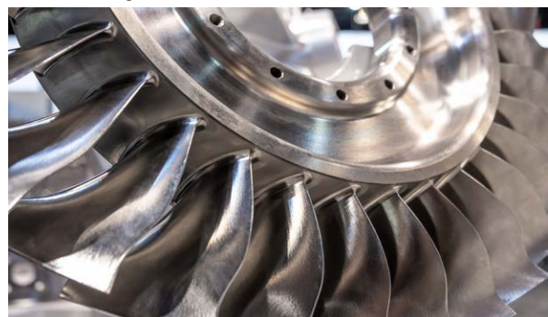
Voorbeeld van een schoepblad met sterk gebogen oppervlakken
