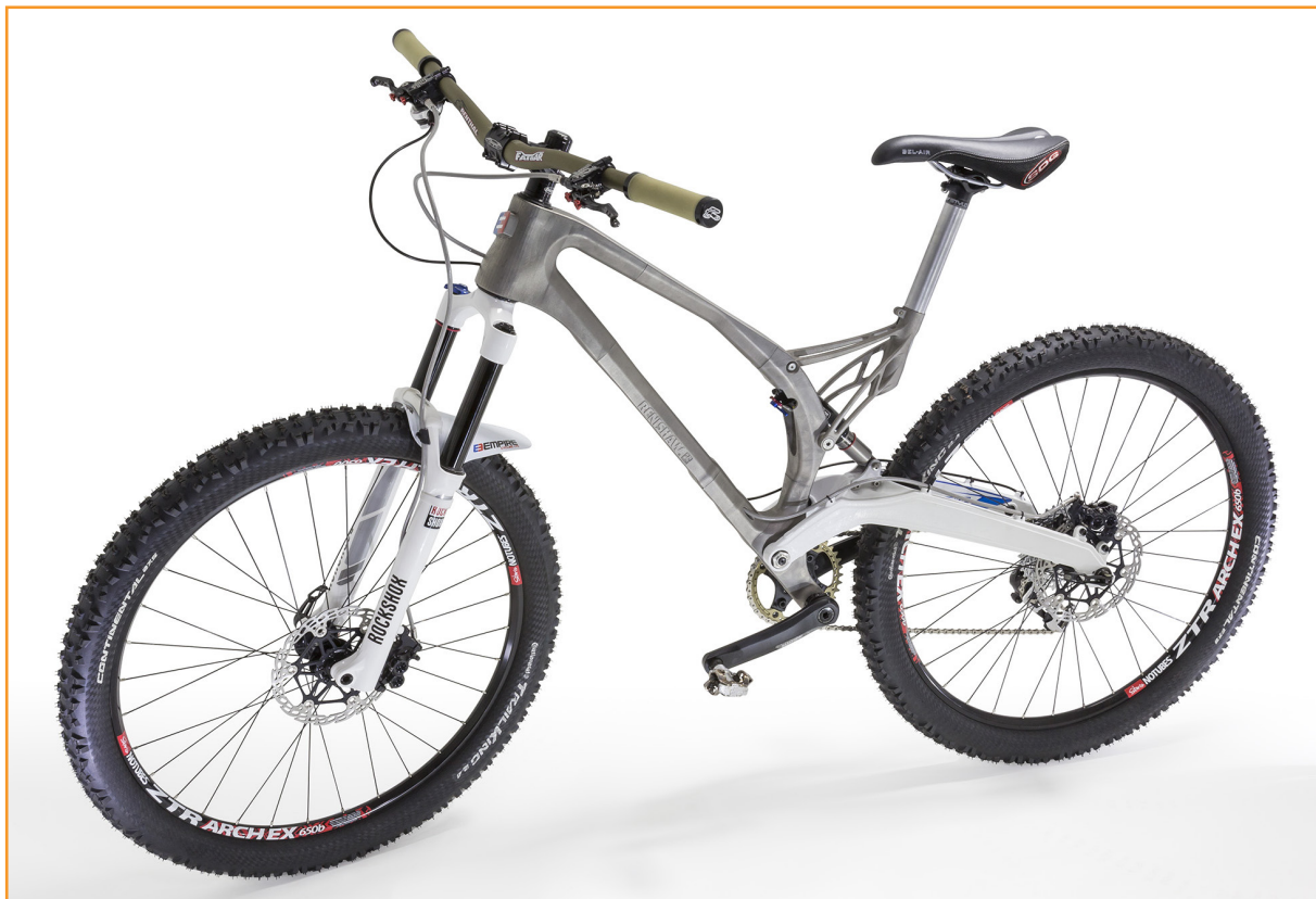
Kompletny rower z wykonaną w technologii druku 3D tytanową ramą i wspornikiem siodła
