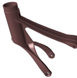
1. Model CAT wspornika siodła zaprojektowany do odlewania ze stopu aluminiowego
