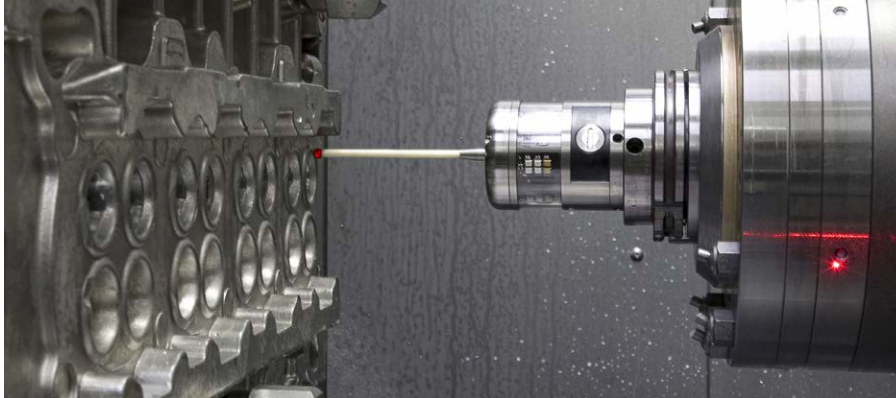
Merilna glava z optičnim prenosom podatkov Renishaw OMP60 meri ključne značilnosti motorja
