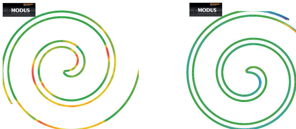
使用 Equator 之後，補償前、後的渦卷形狀誤差比較（紅色為不合格，黃色為極限誤差）
