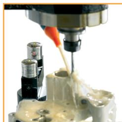
刀具設定裝置可執行加工機切削刀具的動態設定。
