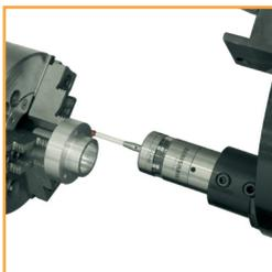
工件量測測頭系列用於自動化的工件位置與定位的座標設定。
