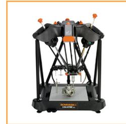
**Equator™** 多用途檢具能用於大量零件生產的快速檢驗。
