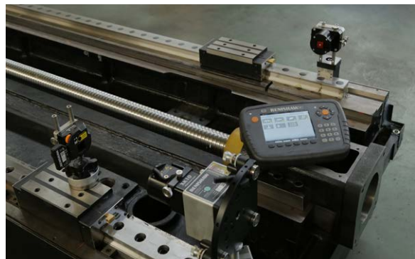
Renishaw XK10 校準雷射系統採用無線通訊
