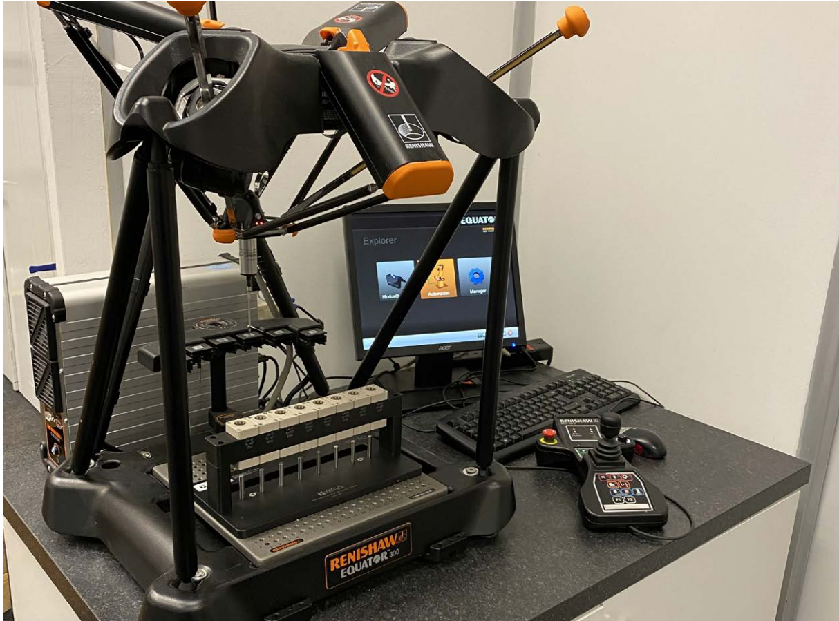
使用Verus的一款夹具承托试剂瓶和瓶盖，以便在Equator™ 300比对仪上进行检测
